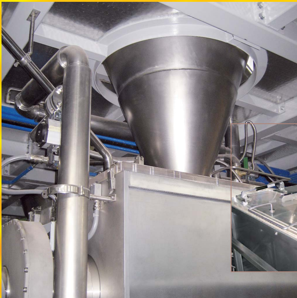
◀ Applicazione industriale del mixer su celle di carico per il dosaggio in automatico degli ingredienti
